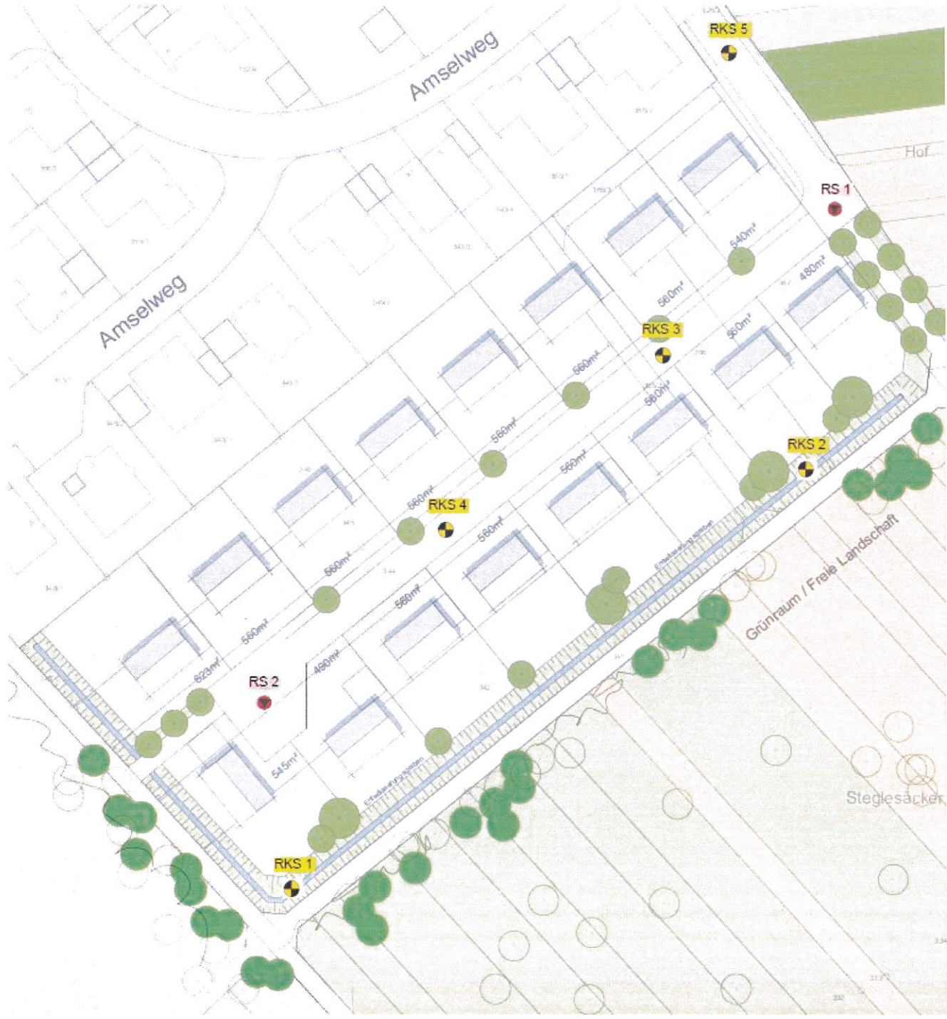
Lageplan mit Kennzeichnung der Untersuchungspunkte Rammkernsondierungen und Bohrkerne
